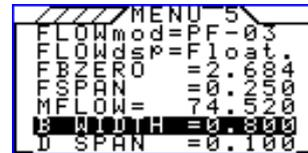
D SPAN = 수로의 바닥면에서 weir 하부의 거리
