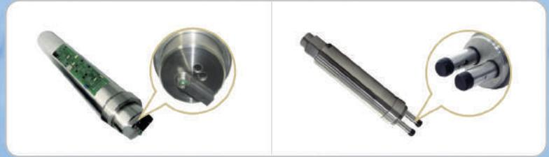
MLSS-100 / SS-100 활성슬러지농도 (Mixed Liquor Suspended Solid) / SC-5000 부유물농도 (Suspended Solid) 측정기는 0~20,000mg/L, 0~10mg/L, 0~100mg/L, 0~1000mg/L까지의 광범위한 부유물질을 임의 설정하여 측정을 가능하게 합니다. 산란광 또는 투과 흡수광 원리에 기초한 센서는 세정장치가 부착되어 있어 표면 세정을 자유롭게 할 수 있고 유지, 관리가 용이한 구조로 설계되었습니다.
